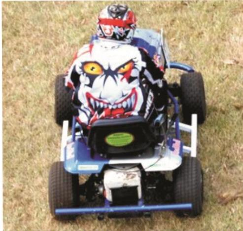
Les pare-chocs ne doivent pas dépasser 80% de la largeur des voies
