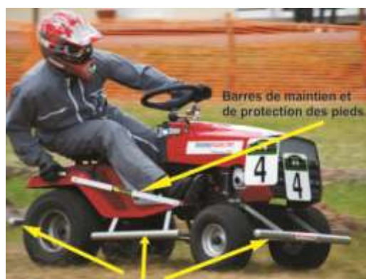
Pare-chocs et barres anti-encastrement au niveau de l'axe des roues
