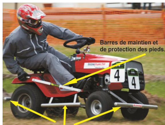
Pare-chocs et barres anti-encastrement au niveau de l'axe des roues
